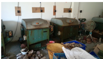
↑ 自動切割機，將原石做初步切割成片狀或塊狀
