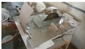
↑ 切割機為濕式作業
